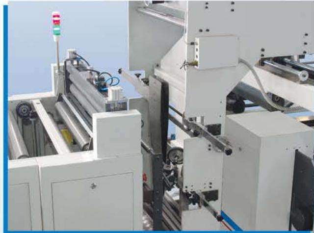
Блок прижимных валков размотчика с сервоприводными танцующими валками
