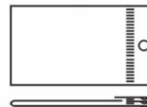
пакеты с бок.сваркой, ультразвуковой сваркой верха, доб.вставкой в верхнюю проваренную часть и пробивкой отверстия
