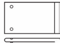
пакеты с бок.сваркой с клейкой лентой и отверстиями для вент-ции
